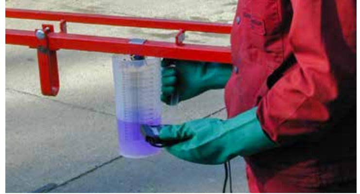
Geräteeinstellung durch Auslitern überprüfen.
