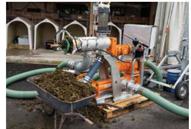
Ein Gülleseparatort kann zur Emissionseinsparung im Bereich der Ausbringung beitragen. Das erzeugte Feststoffseparat kann unter bestimmten Bedingungen auch als Einstreu in Tiefboxen verwendet werden.
