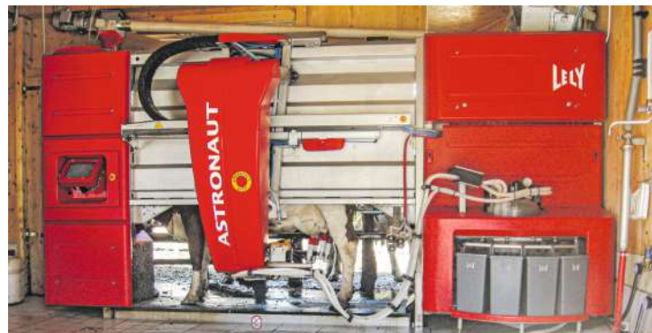
Am Melkroboter werden die angestrebten Zwischenmelkzeiten über die Einstellungen der Melkberechtigungen der Einzeltiere oder gruppenweise gesteuert.
