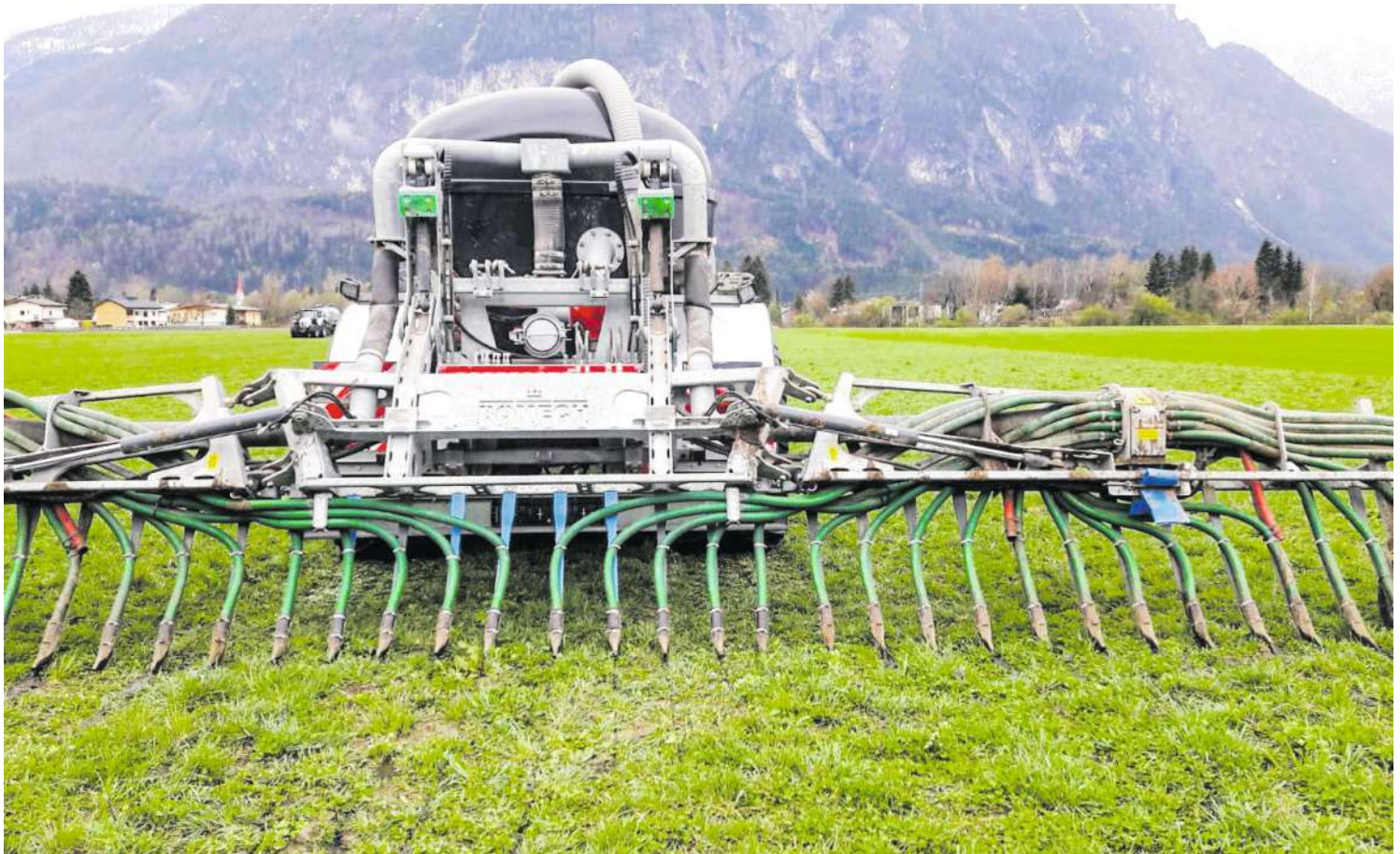
Zur Reduktion der Ammoniakemissionen ist die bodennahe Ausbringung von Gülle eine wichtige Maßnahme, die derzeit noch freiwillig ist und im Rahmen vom ÖPUL gefördert wird.
