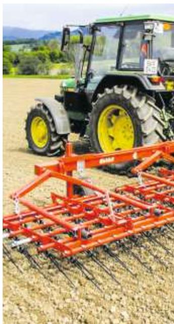
Blindstriegeln, fünf bis sieben Tage nach dem Anbau, ist die wichtigste Maßnahme zur Unkrautregulierung im Biomaisanbau. Unkräuter werden am effektivsten im Keimstadium bekämpft.
