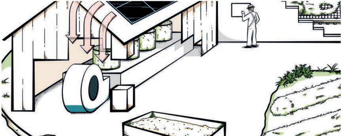
Trocknung ist ein einfacher physikalischer Vorgang, der sich der Wasseraufnahmefähigkeit der Luft bedient. Dabei ist es relativ egal, um welches Trockengut es sich handelt: Holz, Wäsche oder eben Heu. Die durchströmende Luft entzieht der Oberfläche des Trockengutes Wasser (Verdunstung).
