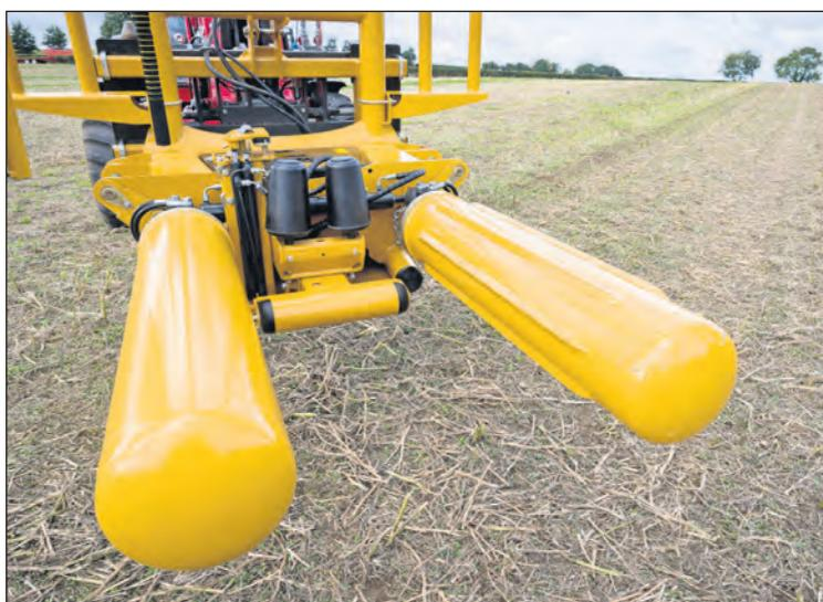
Der neue Ballenaufsteller bei Vari Wrap ist mit einer Auto-Lade-Funktion ausgestattet.
