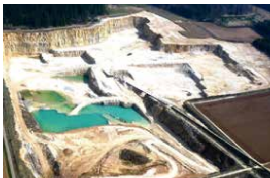
Terrassenabbau durch Absprengung von Kalkstein
