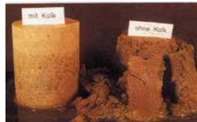
Bodenstruktur-Stabilisierung mit Branntkalk
