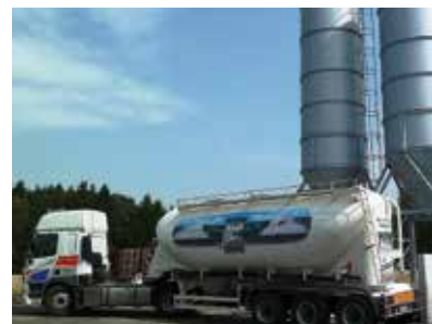
Zwischenpuffersilo – Füllung beim Lagerhaus mit dem Silo-Lkw
